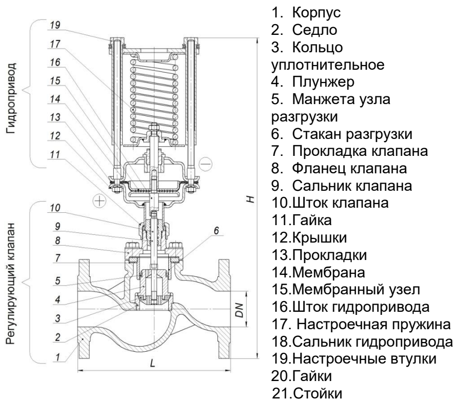
Рис.5 Регулятор УРРД-НЗ DN40-100
